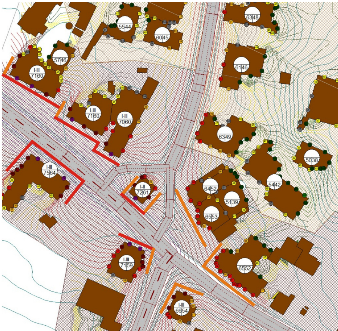
Abbildung 9.5-1: Screenshot aus dem Programm Cadna/A: Verkehrslärmbelastung Prognose-Zustand 2025 mit projektinduziertem Verkehr; orange Linien markieren Überschreitungen des Immissionsgrenzwertes (ES III: 65dB(A)), rote Linien Überschreitungen des Alarmgrenzwertes (ES III: 70dB(A)); alle Gebäude sind der ES III zugeteilt
